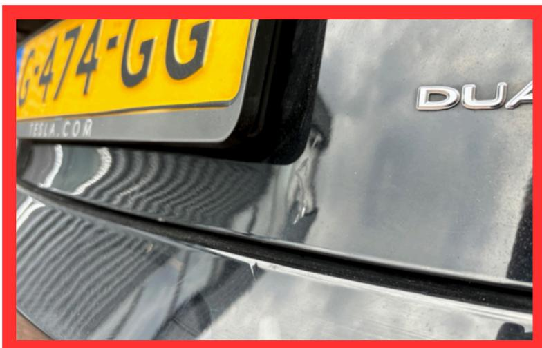
Leicht beschädigte Türkanten betrachten wir als **akzeptabel**. Die Kanten dürfen jedoch keine Dellen oder Faltungen aufweisen. Dellen mit Lackschäden sind **nicht akzeptabel**.
